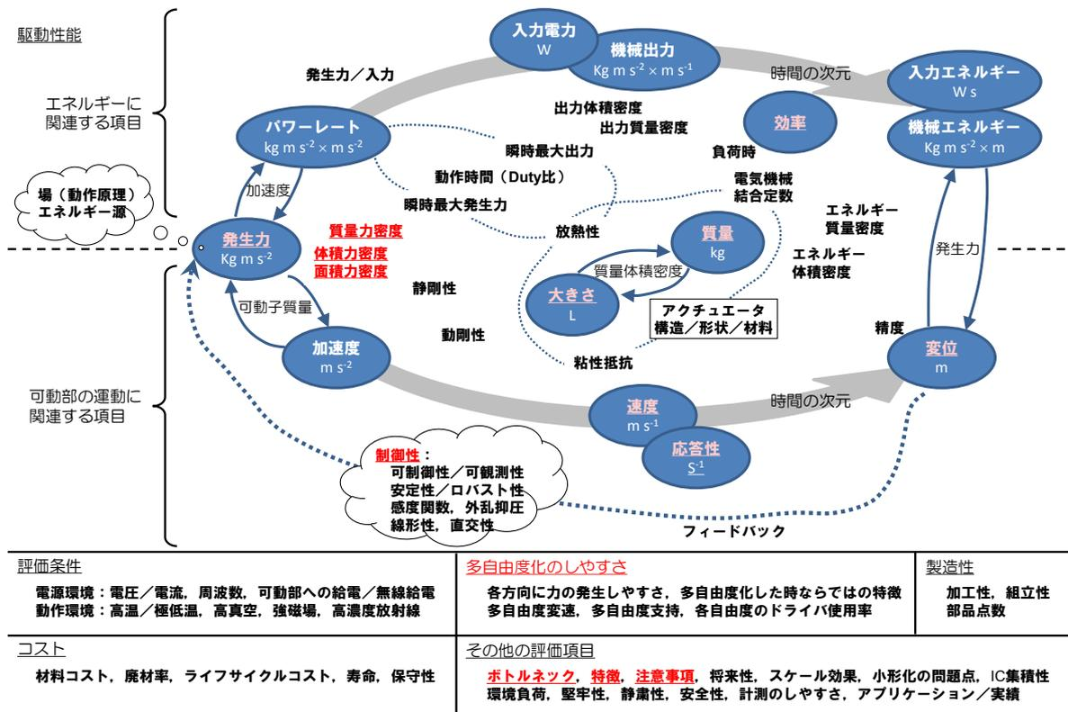
図 1.1 1自由度アクチュエータの評価項目の全体図
