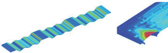
図 3.3.12 新型放熱器の強度解析結果
